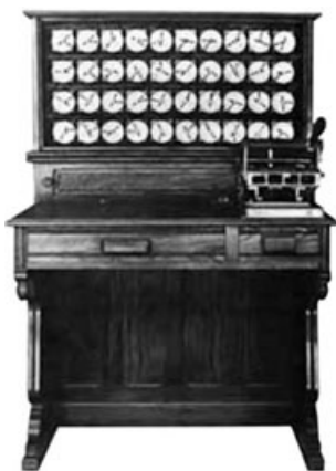
Stroj firmy Hollerith pro práci s děrnými štítky
